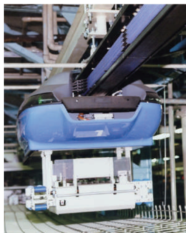
ジャストインタイムでモジュールを組立ラインに供給
