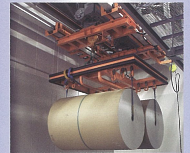
巻取紙搬入ホイス Hoist Crane
