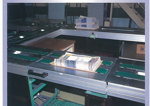
跳ね上げコンベヤ Lift
