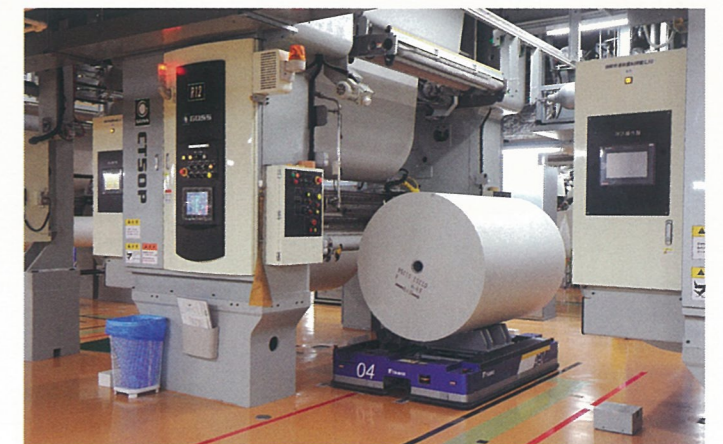
残芯を回収するAGV AGV collecting core
