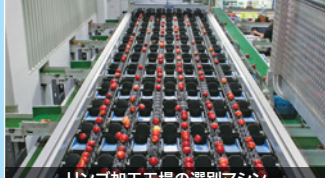
リンゴ加工工場の選別マシン 小形コンベヤチェーン
