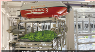
植物工場自動搬送システム オートランバンガード
