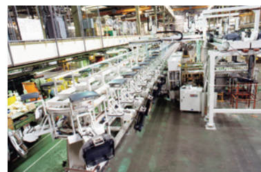
国内外の家電メーカーで採用されたブラウン管塗布工程システム (1982年)
